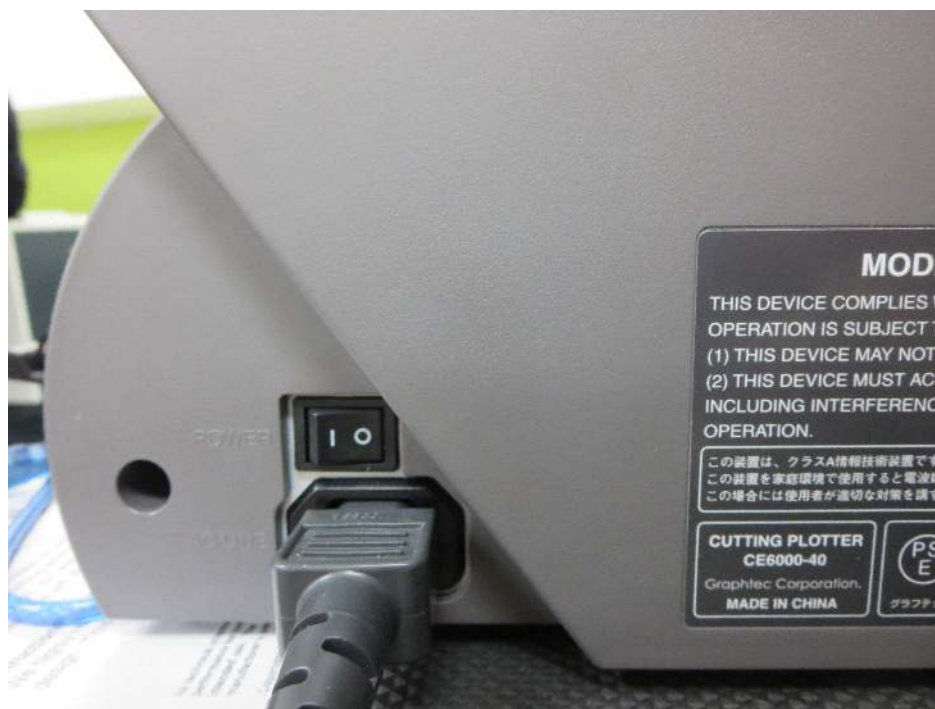
Image 4 : Emplacement de l'interrupteur.
