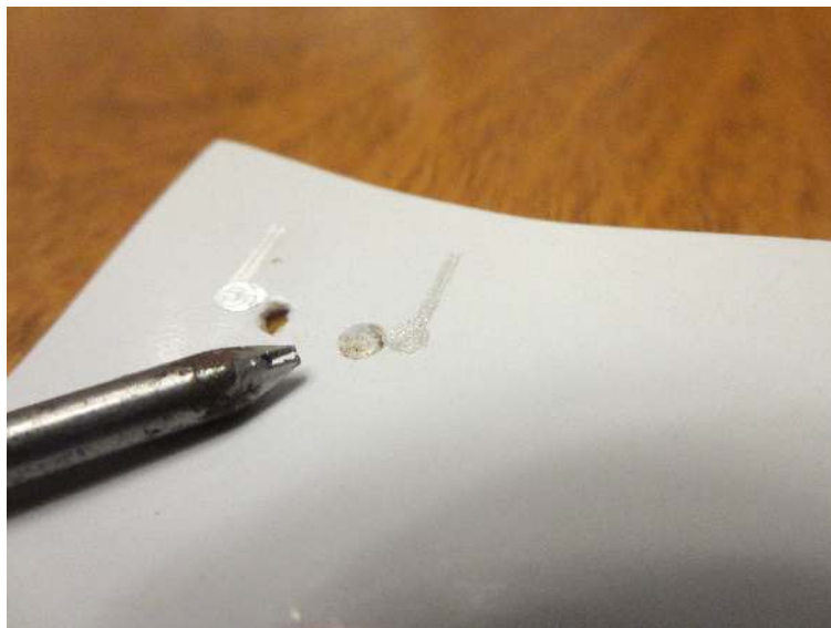
Image 11 : Perçage à l'aide d'un clou.
